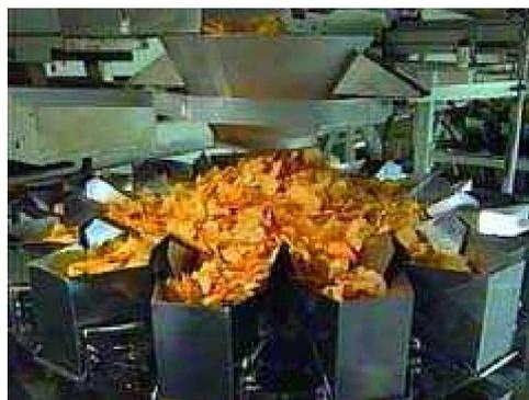
Die fertig gewürzten Kartoffelchips laufen wieder über Fließbänder bis zu dieser Maschine. Hier werden sie in gleich große Portionen aufgeteilt und anschließend in Säckchen abgefüllt
