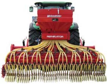
Mit der Sämaschine werden die Getreidekörner auf den Feldern ausgestreut.
