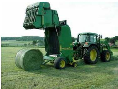
Mit der Rundballenpresse wird das Heu oder das Stroh zu runden Ballen gepresst, die dann auf den Bauernhof gebracht werden.
